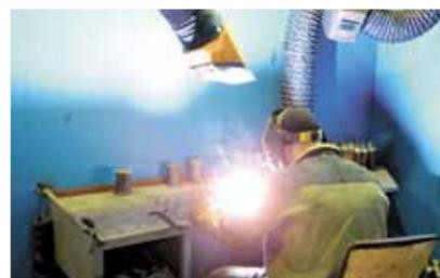
Сварочный пост обеспечивает безопасные условия труда для сварщика и его коллег в цехе
