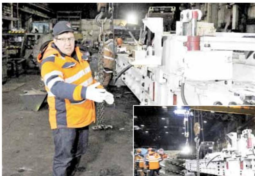
Оборудование применяют для транспортировки и перегрузки горной массы с лавного конвейера, который расположен в очистном забое, на ленточный, находящийся в конвейерном штреке.
